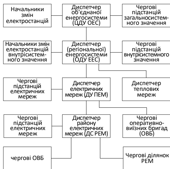
Рисунок 1 – Узагальнена ієрархічна структура диспетчерського управління енергосистемою
